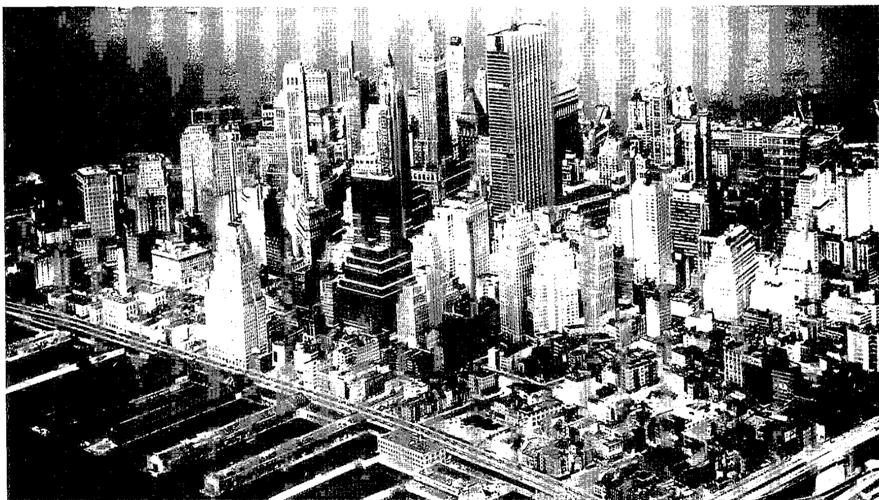
图 38.8 美国纽约。多年来人们一直要求就一定地区的建筑物发展总量与由此产生或要求的交通、电力、下水道、自来水、污染物等之间的数量达成定量关系。曼哈顿是建筑物过度密集的典型。在这张图中可以看到,较早的建筑物的高度和体积还算适中,后来是试图避免对四邻过分遮阴的“阶梯塔形”建筑阶段,最后是大量高耸的摩天大厦不顾后果地发展起来的新近阶段。
