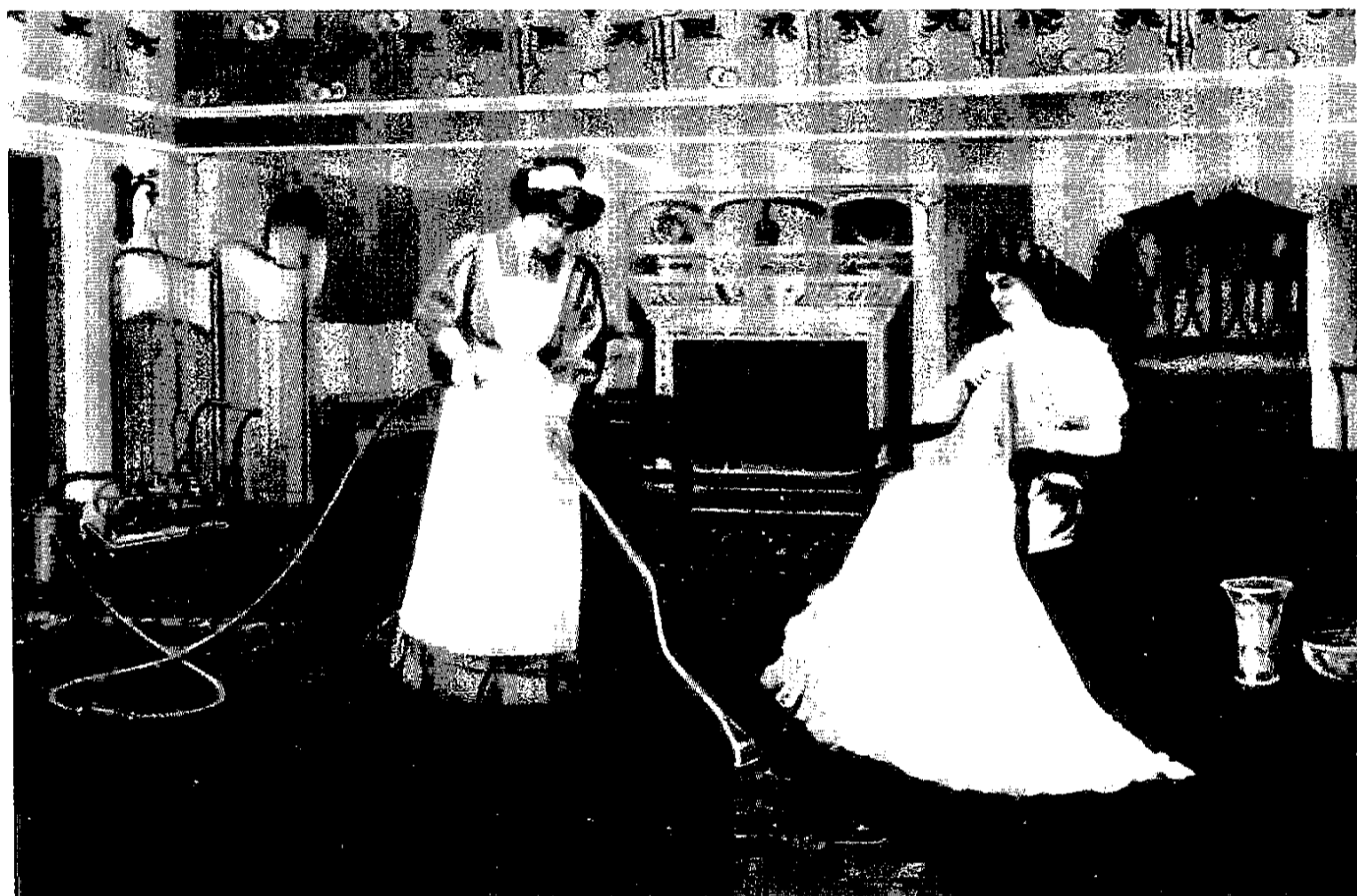
图 47.1 布思的真空吸尘器,一个1904年时的装置模型。直流电动机和真空泵安装在一个手推车上,并把插头插到照明电源上。灰尘被收集在金属罐里。
