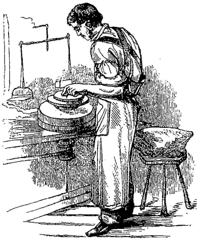
图 192 扁平中空器皿(如盘碟、茶托之类)的冲压方法的引入,加速了廉价器皿的生产。图中的天平是用来称量将要冲压的粘土块的,以使生产的成品标准化。
