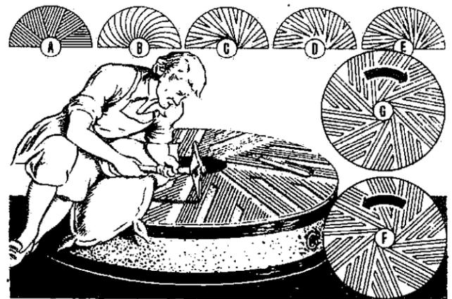
图 118 手工打磨磨石。图中所示的是一些传统的设计图样。上下磨石的修整方法类似。(A)古罗马后期,(B)18 世纪,(C)、(D)、(E)19 世纪,(F)、(G)右旋和左旋的磨石的“四等分”打磨。
