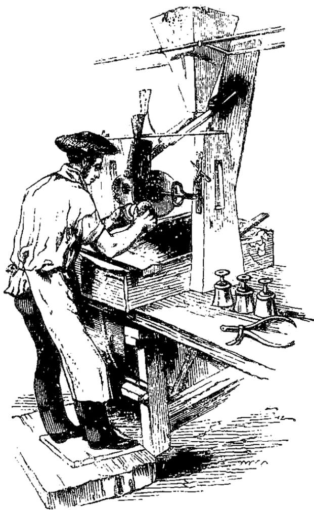
图206 玻璃雕花器皿的打磨工序。
