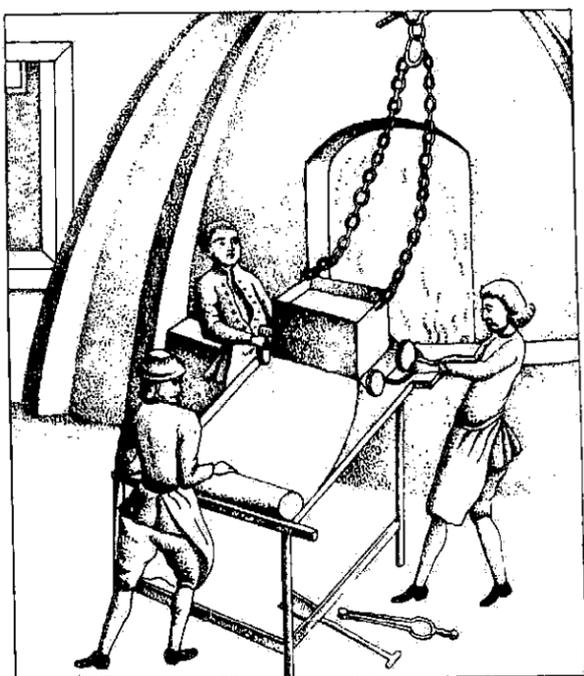
图198 平板玻璃的连续浇注法。约1780年。
