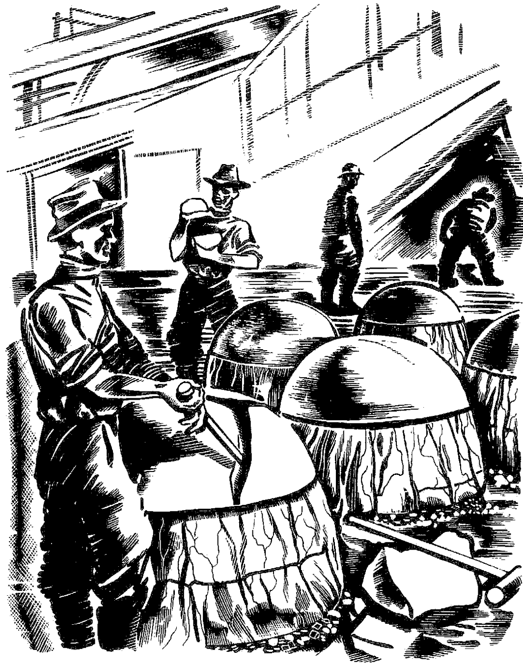
图 32 分离铜和镍的奥福德“顶底分层”工艺过程。
