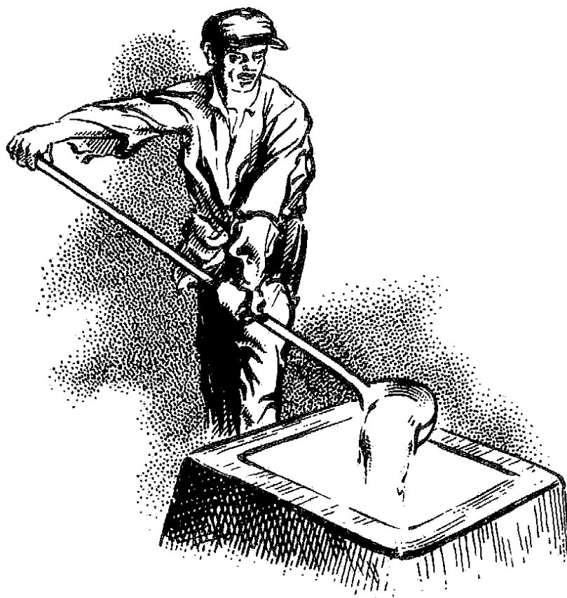
将精炼铜铸成扁平的铜锭,它们将被热轧成铜板。
