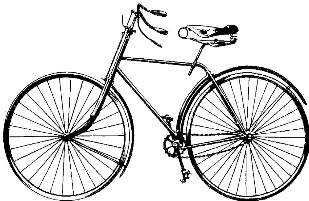
图 222 胜家(Singer)低座自行车,1890 年。注意其转向轴轴线通过轮胎与地面的接触点,这样可改善转向性能。
