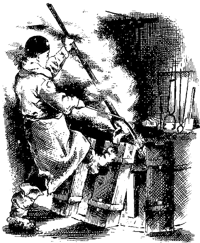
图 320 在铁铸模内浇注黄铜锭。
