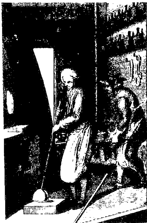
在 18 世纪的一家玻璃工场里手工吹制玻璃瓶。
