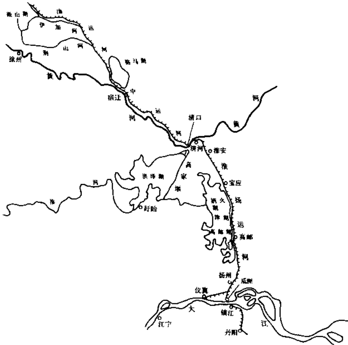
图 7-10 清口枢纽工程——京杭运河与黄河、淮河的交叉工程是为“灌塘济运”(《清史稿·河渠志》)。这种方法用了近 30 年,咸丰五年(1855 年)黄河北徙,运河淮阴至山东段断航。
