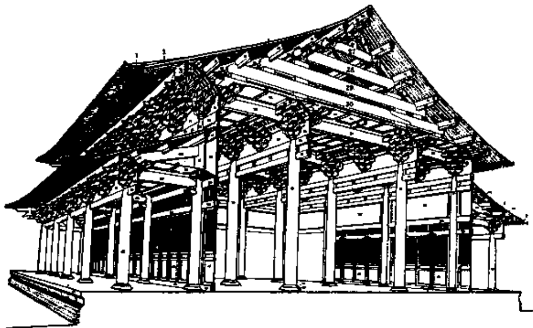
图 8-3(1) 宋《营造法式》大木作示意图(殿堂)①
